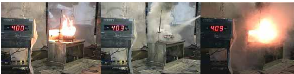
写真 8 ハロンを消火薬剤に使用した商品の消火実験（消防庁資料より）
