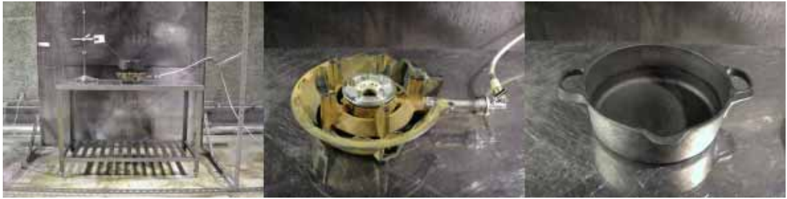
写真 9 天ぷら油火災の消火試験に使用した器具
