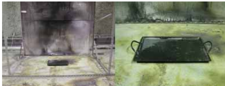
写真 10 灯油の火災の消火試験に使用した器具
