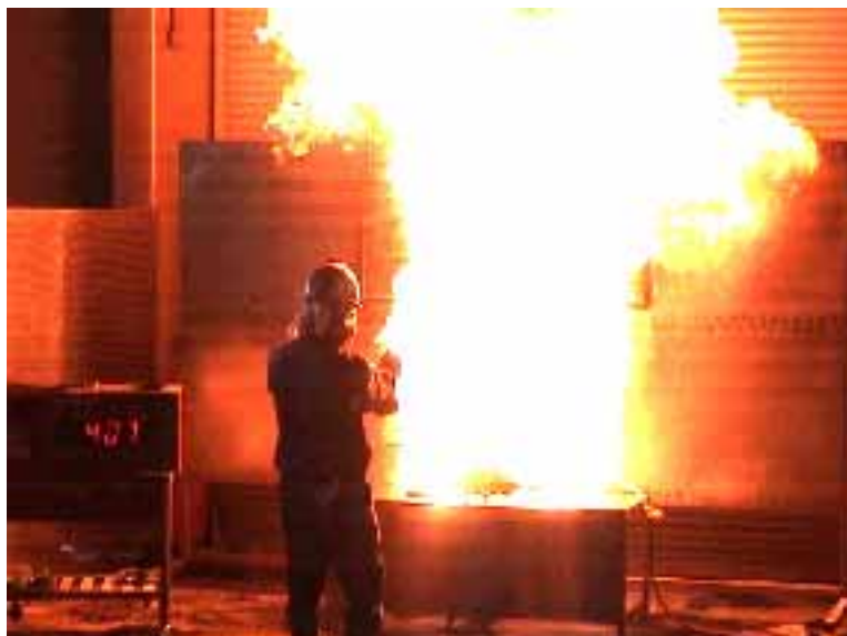
写真3 輸入品の銘柄による天ぷら油火災の消火時に噴き上がった炎
