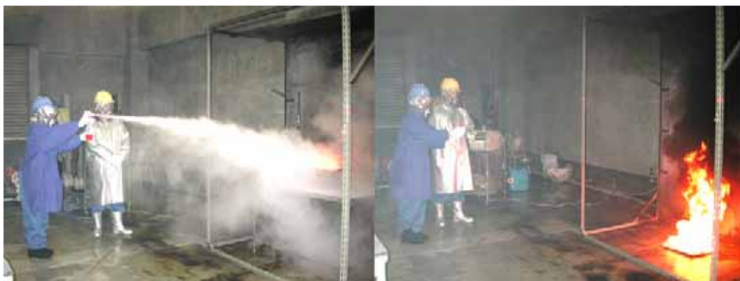
写真2 消火性能のモニターテスト風景（左：天ぷら油火災 右：灯油火災）
