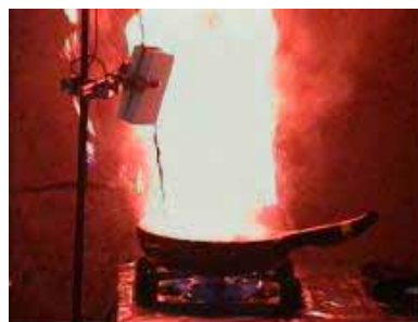
③ 炎が大きくなり（高さ約 1m）、約 2 秒間激しく燃える
