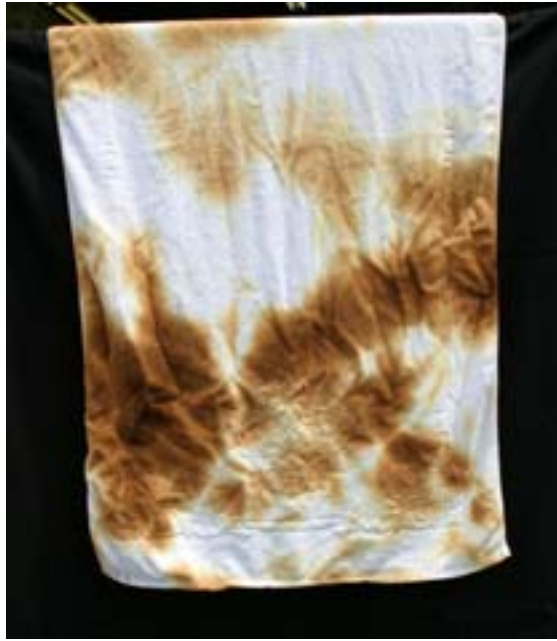
写真3. 洗濯槽内で発煙したバスタオルの例
