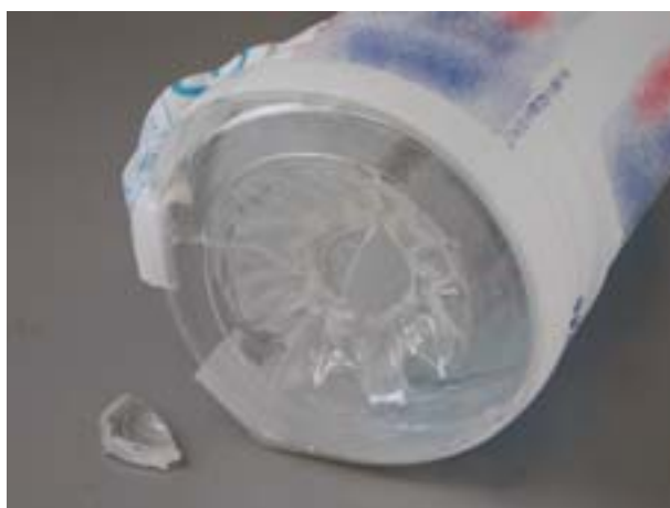
写真 4. 照明器具を破損させたペットボトルの底部
