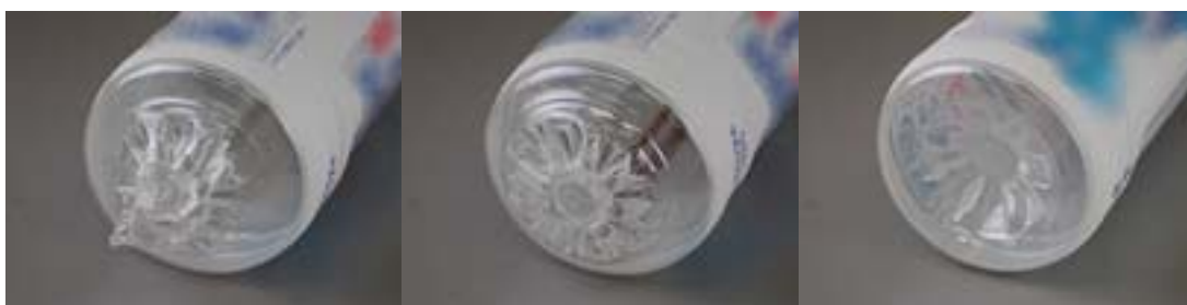
写真 2. 銘柄 1 のボトル底部の様子(左:破裂したボトル、中:破裂しなかったボトル、右:テスト前のボトル)
