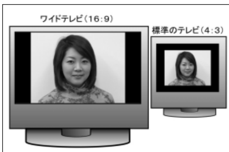
図 8. 標準放送をワイドテレビと 4:3 のテレビで見た場合の映像例
