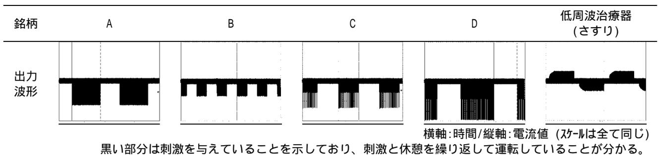
図 4 群波形(10 秒間に発生する波形の様子)の例 (強度設定が最大の時)
