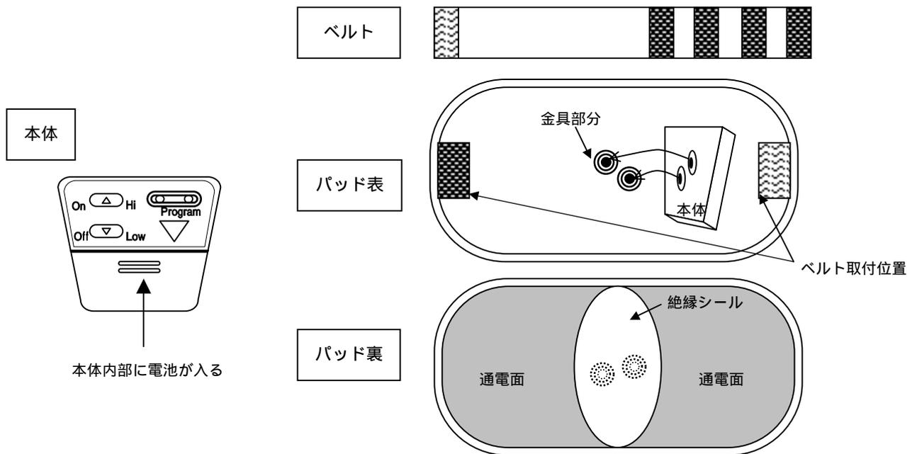
図1 EMSベルトの概略図(例)
