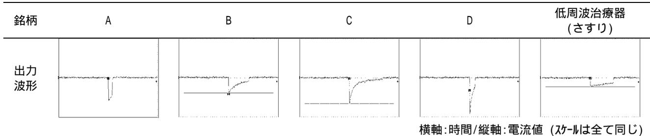
図 3 基本波の例 (EMS ベルトの強度設定が最大の時)
