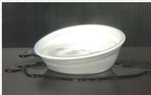
容器が破損し、湯が漏れ出した様子
