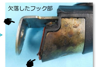
欠落したフック部 焦げて炭化した樹脂部
