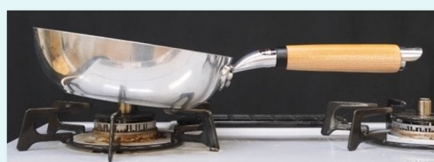
バネの力で小径のフライパンが傾くほど押し上げられた様子
