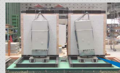
▲写真3 震度6強の振動試験後のようす (左: M12の芯棒半分のみ打ち込み 右: M10の芯棒半分のみ打ち込み)
