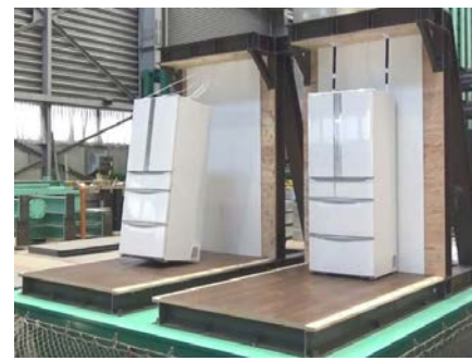
▲写真2 震度6強の振動試験後のようす (左: 固定なし, 右: 突っ張り棒)
